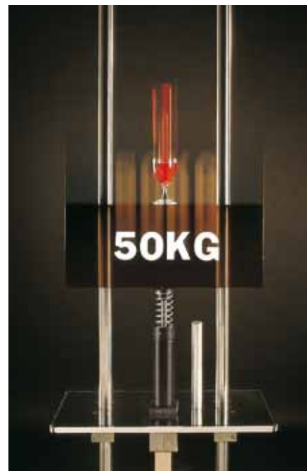
Nel dimostratore ACE un bicchiere di vino scende in caduta libera per 1,3 metri; frenato da un deceleratore ACE, non si versa neanche una goccia.
