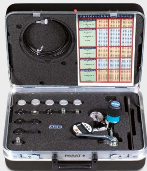
Il kit di ricarica contiene tutte le campane di riempimento e le manopole di regolazione per l'attuale gamma di molle a gas ACE.
