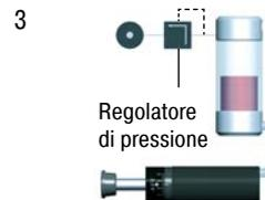
La forza di riarmo può essere modulata tramite il regolatore di pressione. Assicurare una pressione minima per il riarmo del deceleratore in tutta sicurezza.
