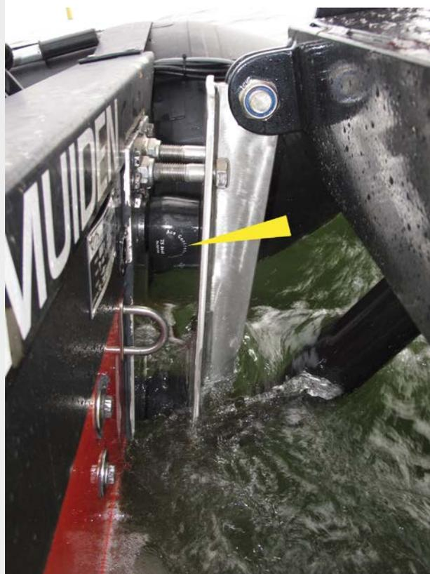
I robusti profili di ammortizzamento TUBUS, resistenti all'acqua di mare e realizzati in elastomero di copoliestere, consentono agli equipaggi delle navi di attraccare in tutta sicurezza
