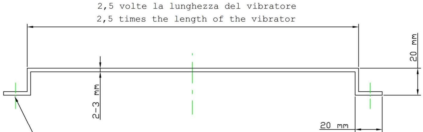
Superficie da saldare durante il montaggio su struttura da vibrare nel caso di lamiera in acciaio
