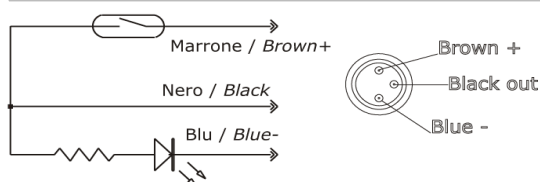
SFL / SFV Collegamenti circuito C
